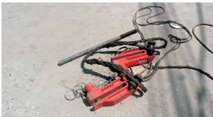
Самоотдающиеся грузозахватные устройства позволяют экономить время на строительных площадках.
