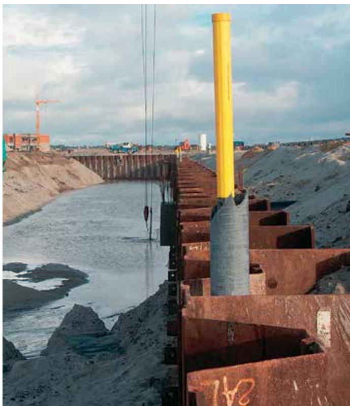
Подтверждение допустимой несущей способности сваи на вертикальные нагрузки (1800 кН) путем проведения динамического испытания.
