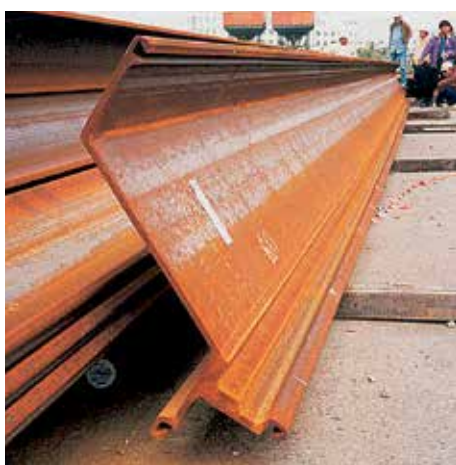
Различные соединительные сваи использовались для оформления поворотов стенки и перехода с одного типа свай на другой.
