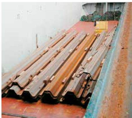
Основная часть шпунтовых свай доставлялась в Прёвестенен судами.
