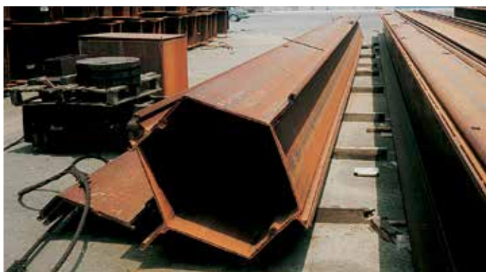
Коробчатая свая типа CAZ 36 с тремя приваренными замковыми соединениями, установленная в месте пересечения анкерных стенок.
