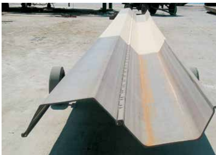
Трехслойное антикоррозийное покрытие на сваях со стороны акватории.
