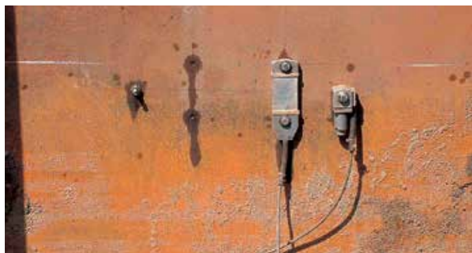
Подтверждение допустимой несущей способности сваи на вертикальные нагрузки (1800 кН) путем проведения динамического испытания.
