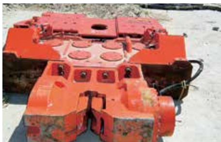
Оборудование для установки свай включало вибропогружатель.
