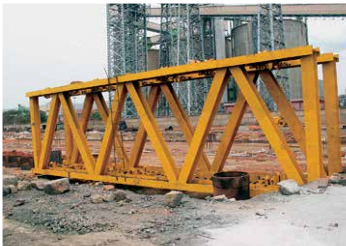
Направляющий кондуктор изготавливался в Индии на основании чертежей, предоставленных компанией ArcelorMittal.
